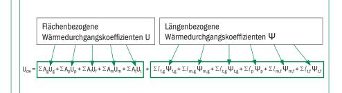
Abb. 12: Formel zur Berechnung des Wärmedurchgangskoeffizienten U<sub>CW</sub> von Fassaden nach dem Verfahren mit Beurteilung der einzelnen Komponenten. Der U<sub>CW</sub>-Wert setzt sich aus fünf flächenbezogenen Wärmedurchgangskoeffizienten U und sechs verschiedenen linearen Wärmedurchgangskoeffizienten Ψ zusammen [3].
